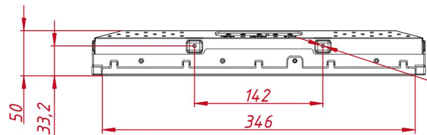
M4x8 отв. (на каждом торце по два отверстия), максимальная глубина резьбового отверстия 4 мм
