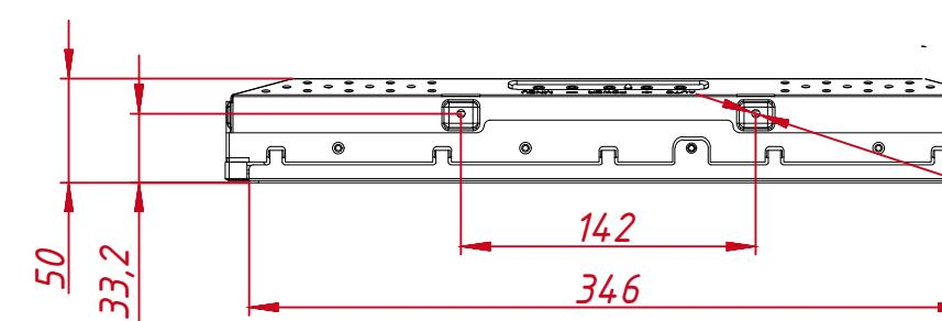
M4x8 отв. (на каждом торце по два отверстия),
