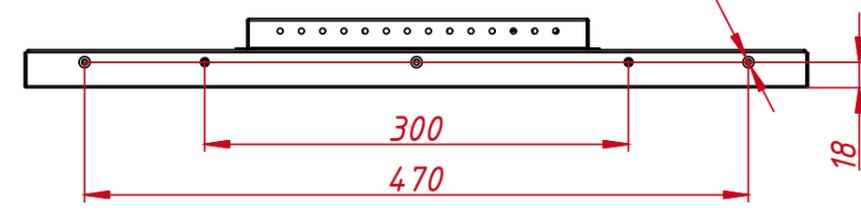
M4x4 отв. для VESA (максимальная глубина резьбового отверстия 4 мм)
