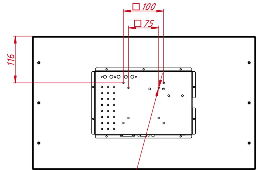
M4x16 отв. (на каждом торце по четыре отверстия), максимальная глубина резьбового отверстия 4 мм
